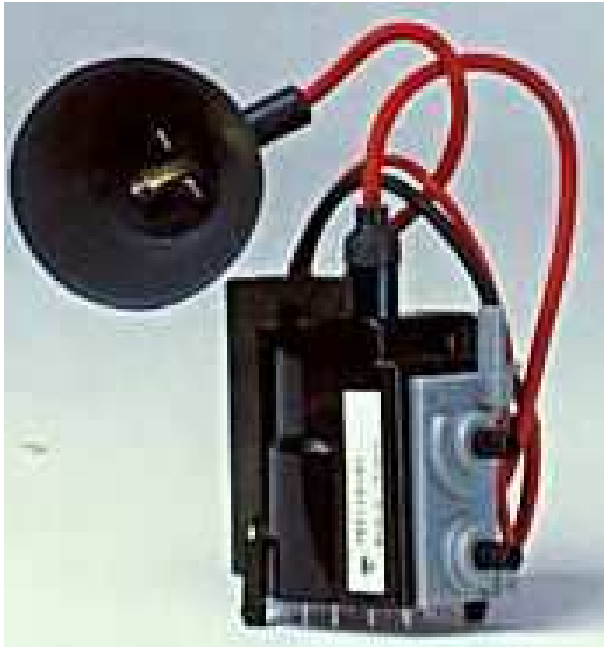
Figura - Detalhe do transformador fly-back (obtenção da muito alta tensão MAT)
